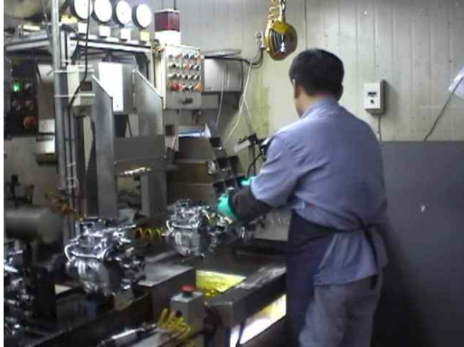
<그림 27> VE 완성조립 기밀시험
