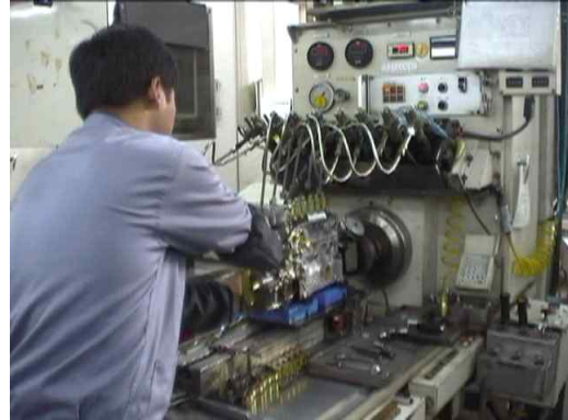
<그림 35> PE-P 조정 (펌프 장착)
