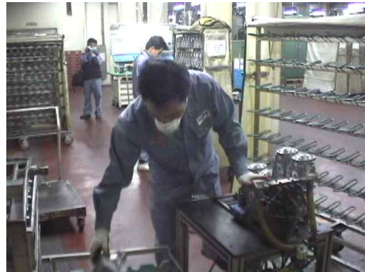
<그림 10> 함침후 에어보드 작업
